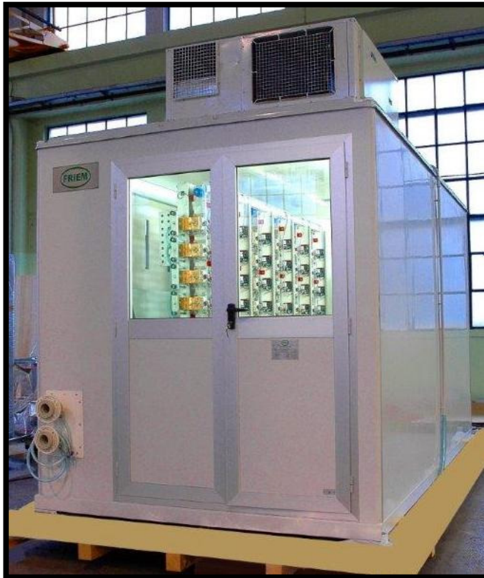
40kA-500V – Dupla ponte 12 pulsos Tiristor
